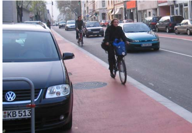
Komfortable Radverkehrsführung mit Radstreifen auf überbreiter Fahrbahn...
